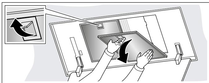
**4 Wyjąć metalowy filtr przeciwłuszcza z mocowania.**
